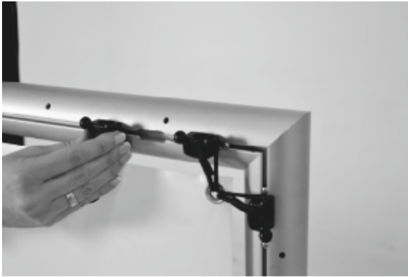
Mausbinder in die Nut des Rohres stecken (so viele, wie benötigt werden)
